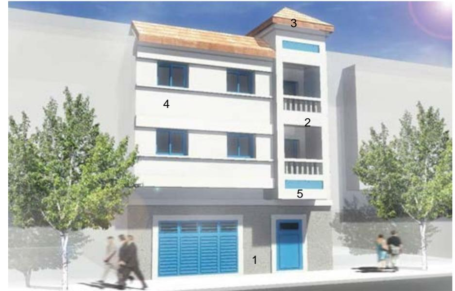
1-soubassement en enduit rugueux / 2-garde-corps de balcon en béton blanc / 3- Toiture inclinée en tuile naturelle/ 4- menuiserie colorée / 5- Frise en zellige.
